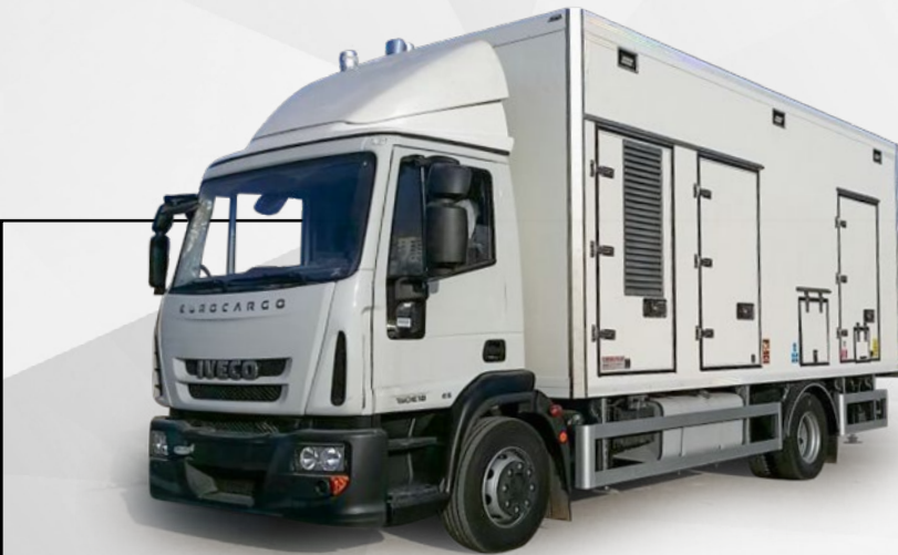
Mobil Jeneratör Aracı
